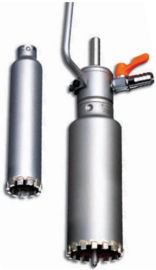
1- Utilizar el punzón guía al iniciar el taladro. 2- Extraemos el punzón cuando la corona haya penetrado levemente.
